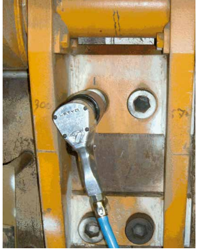
↑ jGUN-3-S küçük Planet dişli yapısıyla en dar alanlarda çalışma imkanı
