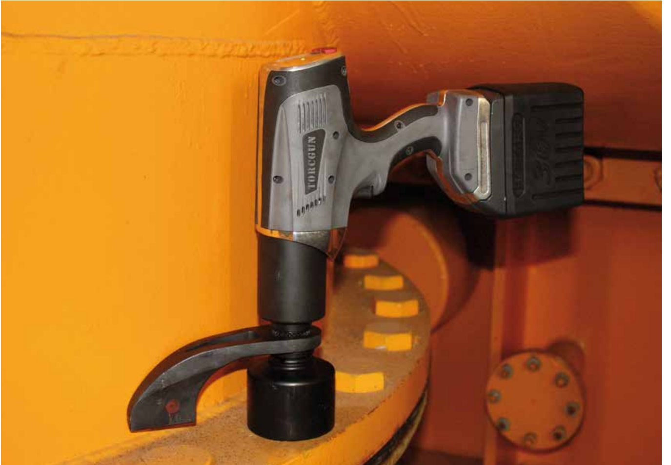
↑ BTM-1000 Basınçlı kaplar ekipmanlarında kullanım
