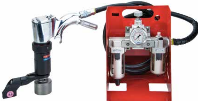
↑ jGUN çift hızlı ve şartlandırıcısı ile birlikte
