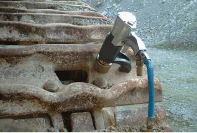
↑ jGUN-3-S palet bağlantılarında
